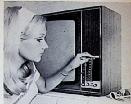
Afb. 10. Instelling der convergentie bij de Metz KTV-ontvanger geschiedt door optichten van het paneel, waarop de schuifpotmeters zijn aangebracht.
